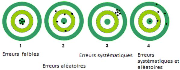
Un appareil de mesure défectueux, mal étalonné ou mal utilisé, conduit à des valeurs proches les unes des autres mais éloignées de la valeur vraie, c'est ce que l'on appelle l' erreur systématique
