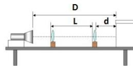
Sur ce banc d'optique que l'on veuille mesurer D, L ou d deux lectures de mesures sont nécessaires, on aura donc pour ces trois grandeurs:
